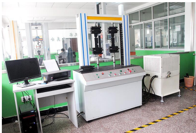
图 5-8 双工位动态疲劳试验机
